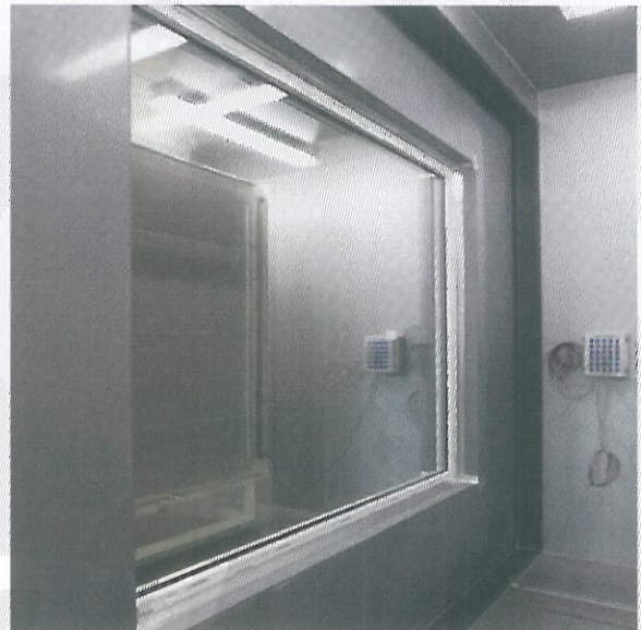
<사진 2> 열관류율 저온측 시험체 모습
