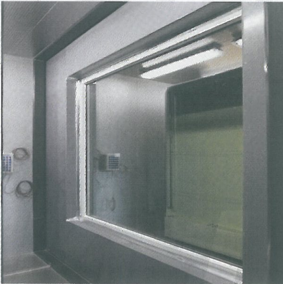
<사진 1> 열관류율 항온측 시험체 모습
